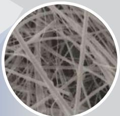
As partículas sólidas, por sua vez, ficam retidas no interior das nanofibras, causando a saturação do elemento. Por essa razão, os filtros coalescentes também são notáveis pela elevada eficiência em promover a "filtração em profundidade".
