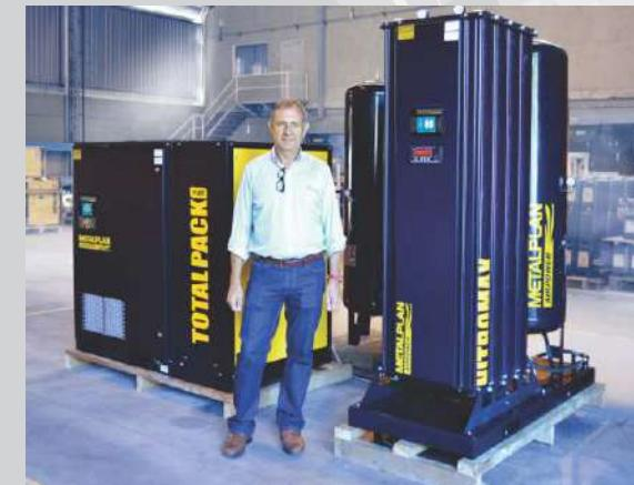
Na seção de testes de estanqueidade dos compressores frigoríficos, a Bitzer utilizava nitrogênio gasoso fornecido por um tanque criogênico. Visando a redução dos custos de produção e melhor controle sobre os processos, foi adquirido um gerador de nitrogênio NitroMax, que vem funcionando ininterruptamente desde 2004.
